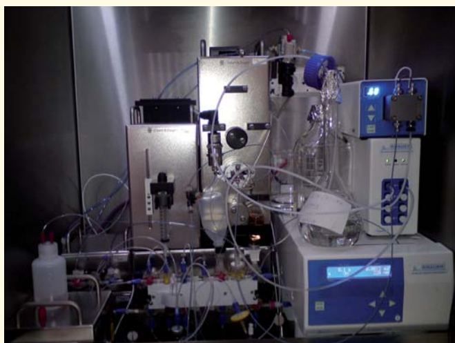
Figura 1: Módulo de Síntese da Eckert & Ziegler para a Produção de Péptidos Marcados com 68 Ga-, 111 In-, 177 Lu- ou 90 Y- DOTA, instalado no Serviço de Medicina Nuclear do IPO-Porto – Esquerda e centro da imagem: módulo de síntese; canto inferior esquerdo: gerador de 68 Ge/ 68 Ga; direita (branco e azul): sistema HPLC para controlo de qualidade.
